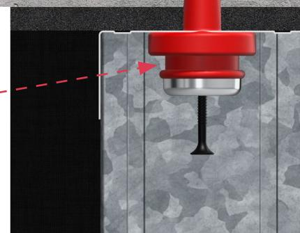
**TAV-500/11 R** tapón acústico fabricado con un polímero renovado (**KRAIBURG-TPE**). Sistema ensayado según norma **UNE-EN ISO 10846-1:2009** presentan un factor de amortiguamiento mayor y un alto grado de aislamiento a vibraciones en el rango de las medias/bajas frecuencias (Hz).
