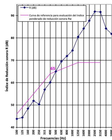
Índices según UNE-EN ISO 717-1:2013: R<sub>w</sub> (C; C<sub>tr</sub>): 65 (-2; -7) dB
