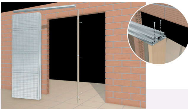
3. Acoplamiento del perfil superior al montante de madera. Attaching track to wooden upright. Assemblage du profilé sur le montant en bois.
