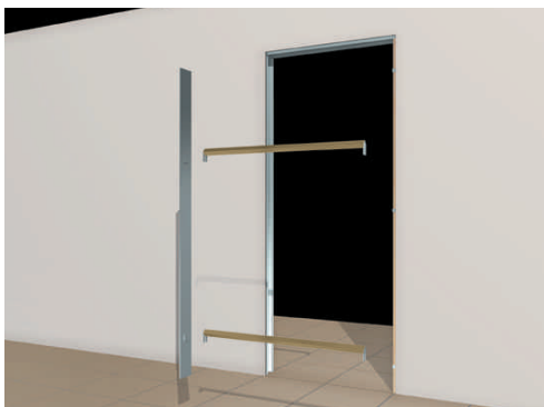
1. Extraer los distanciales y la tapeta lateral. Remove the spacers and side cover. Extraire les séparateurs et le cache latéral.
