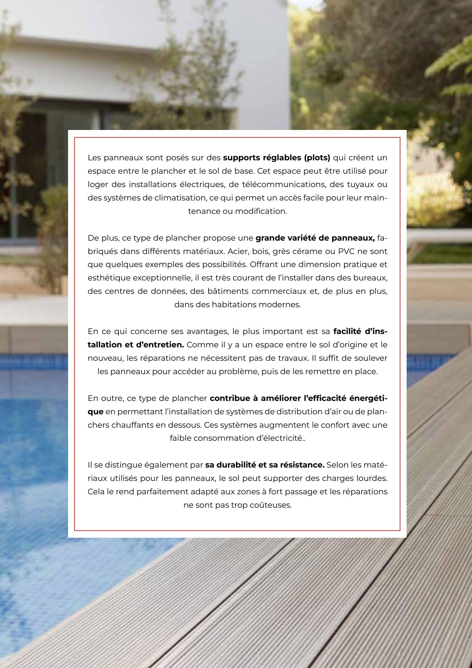
Les panneaux sont posés sur des **supports réglables (plots)** qui créent un espace entre le plancher et le sol de base. Cet espace peut être utilisé pour loger des installations électriques, de télécommunications, des tuyaux ou des systèmes de climatisation, ce qui permet un accès facile pour leur maintenance ou modification.
