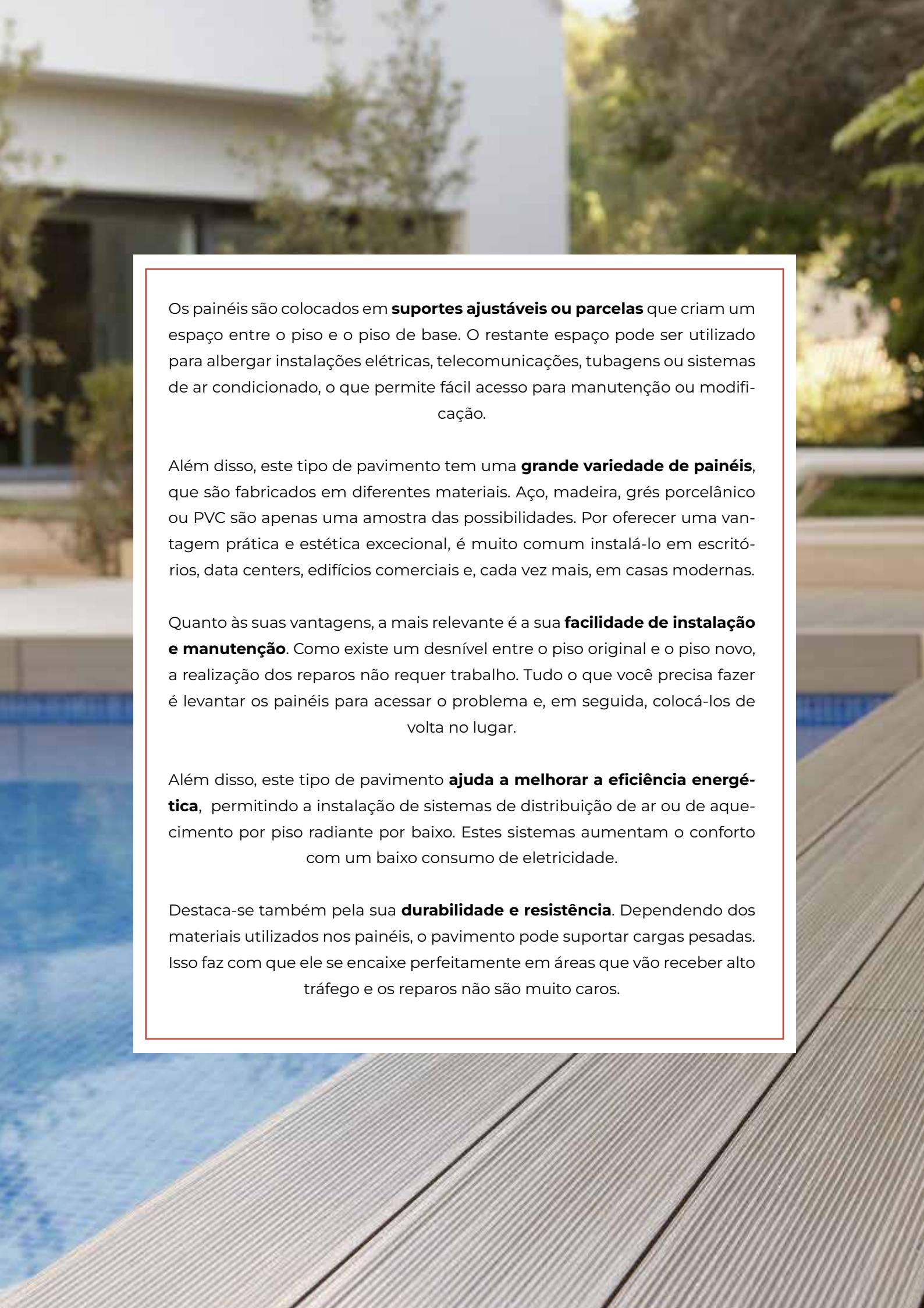
Os painéis são colocados em **suportes ajustáveis ou parcelas** que criam um espaço entre o piso e o piso de base. O restante espaço pode ser utilizado para albergar instalações elétricas, telecomunicações, tubagens ou sistemas de ar condicionado, o que permite fácil acesso para manutenção ou modificação.
